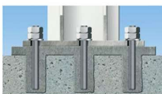
Lestage mécanique de la structure par scellement chimique / mécanique
