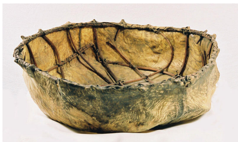
Les Bull Boats font partie de la famille des coracles. Ils ont été créés par les peuples indigènes d'Amérique. Leur coque est constituée d'une peau de bison tendue.
