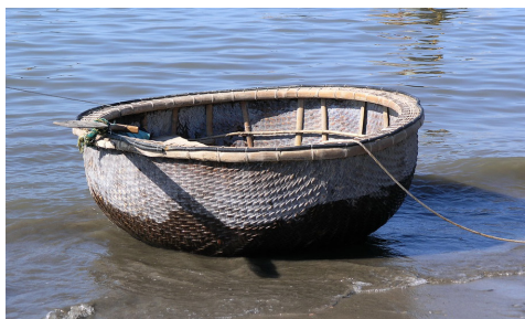
Les coracles vietnamiens sont entièrement réalisés en vannerie. Ils sont très répandus dans le pays, notamment dans les régions sujettes aux inondations. Ils servent à la fois à la pêche mais aussi à assurer les récoltes dans les champs inondés ou de moyen d'évacuation quand les inondations sont trop fortes et ne permettent plus de vivre dans la région.
