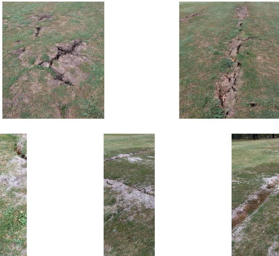
Figure 77 : Exemple d'impacts liés au retrait des argiles
