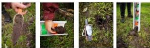
Figure 22 : Déroulement du protocole des investigations pédologiques (Source : CERAG)
